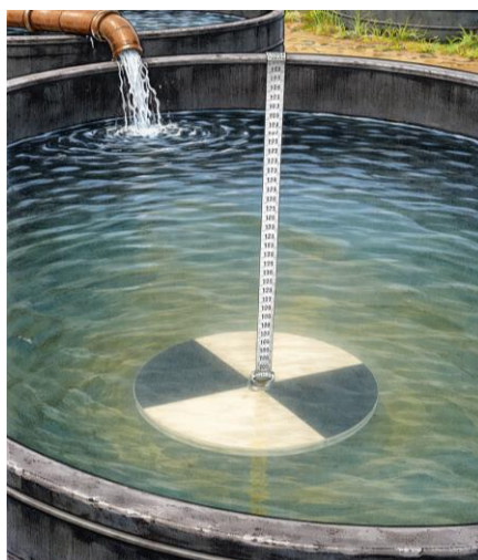
Figura 63. Disco de Secchi usado para medir a transparência da água em um tanque.
