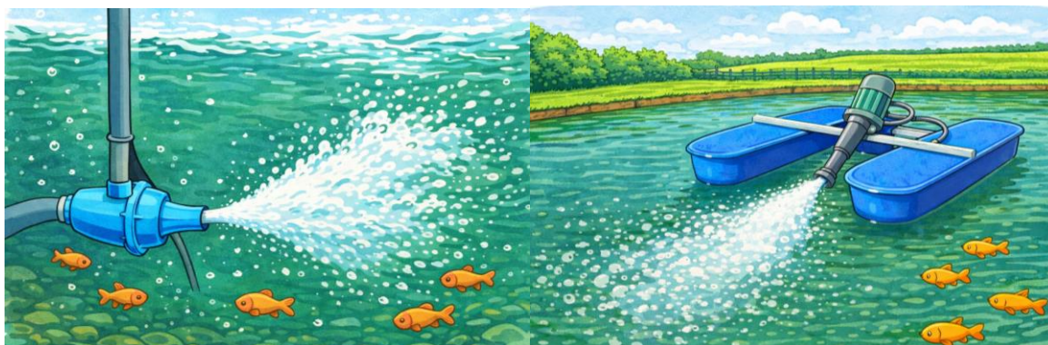
Figura 59. Aeradores que injetam ar na água: injetor do tipo Venturi, turbinas injetoras ( propeller-aspirator-pump ), soprador com difusor.
