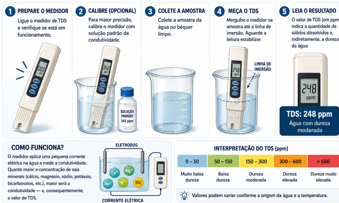
Figura 71. Medidores eletrônicos (TDS) da condutividade elétrica da água.
