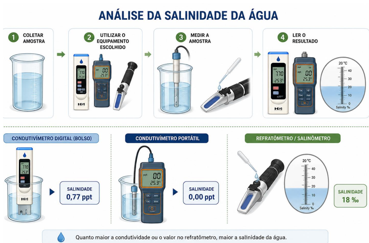
Figura 75. Monitoramento da salinidade da água com condutivímetro e refratômetro.
