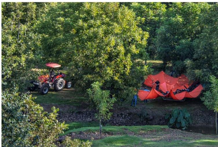
**Figura 10.** Agitador-colhedora tipo guarda-chuva invertido.
