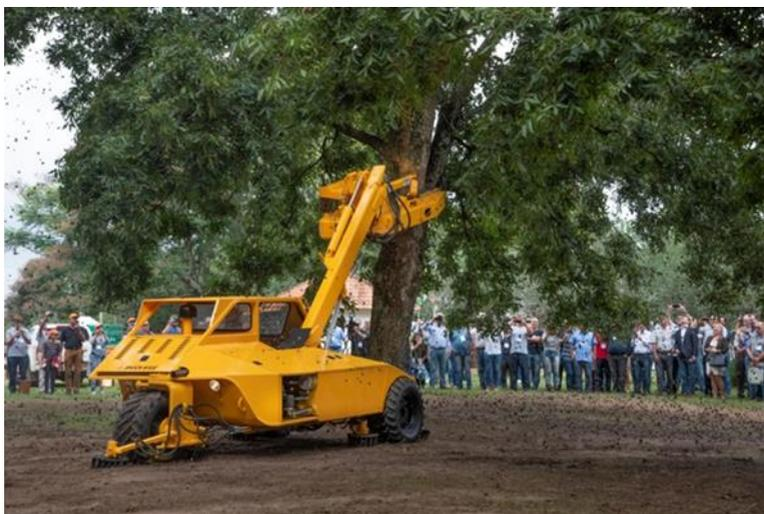
**Figura 8.** Equipamento agitador de tronco.
