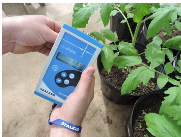
Figura 4. Determinação do índice de clorofila foliar das plantas de tomateiro por meio do clorofilômetro ClorofiLOG CFL 1030.
