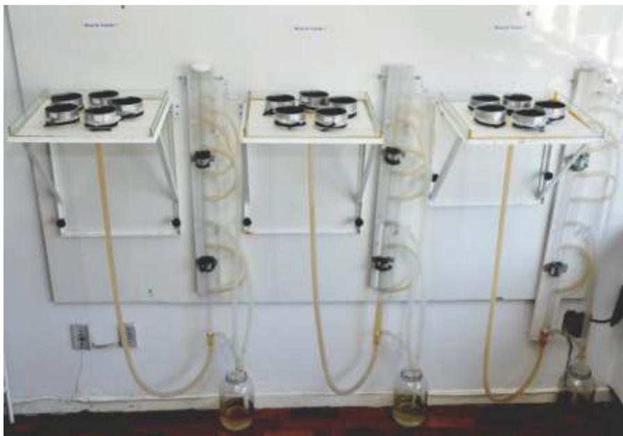
**Figura 5.** Conjunto de mesas de tensão para determinação de curva de retenção de água: três mesas, cada uma com uma coluna, independente. **Fonte:** Autor.
