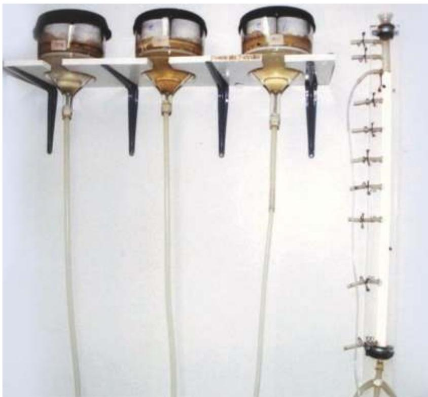
**Figura 6.** Conjunto de funis de tensão (23 cm de diâmetro) para determinação de curva de retenção de água. **Fonte:** Autor.
