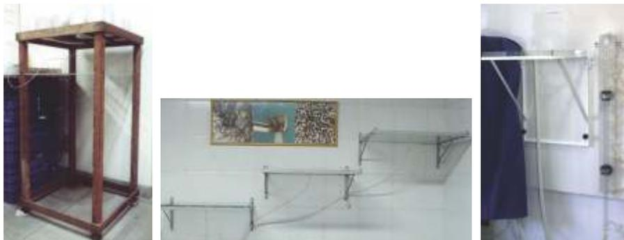
**Figura 4.** Modelos de mesa de tensão para determinação de curva de retenção de água: a) mesa com pés e tampa de madeira, superfície de vidro e sistema de vasos comunicantes feito com um kitasato; b) sistema com mesa de ferro e superfície de vidro, a 10, 50 e 100 cm, suspenso na parede; c) mesa de ferro, superfície de vidro e sistema de vasos comunicantes feito com uma coluna de vidro. **Fonte:** Solange Brum
