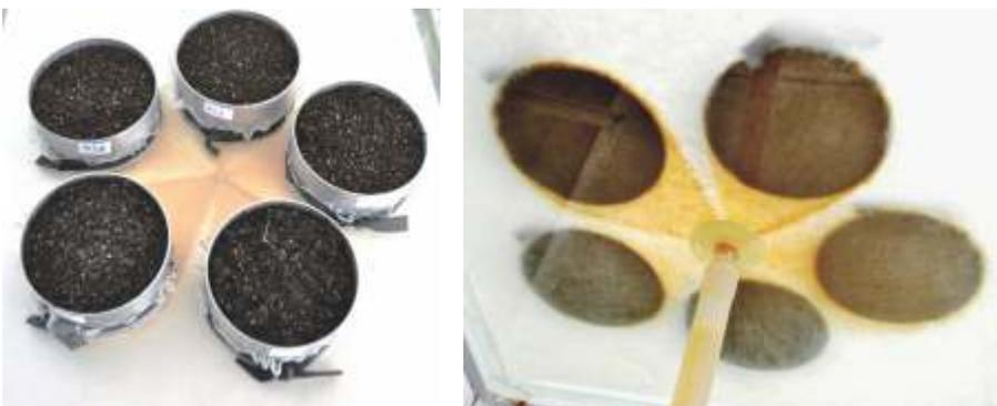
**Figura 8.** Anéis (cilindros de alumínio) colocados sobre a mesa de tensão (vista superior e inferior). **Fonte:** Solange Brum.
