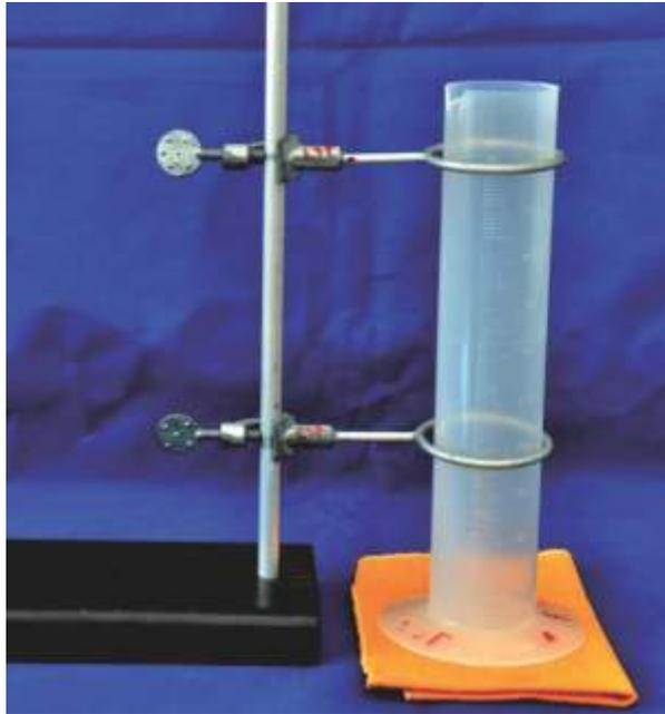
**Figura 1.** Suporte universal, anéis e proveta de 500 mL para determinação da densidade pelo método da autocompactação. **Fonte:** Solange Brum.
