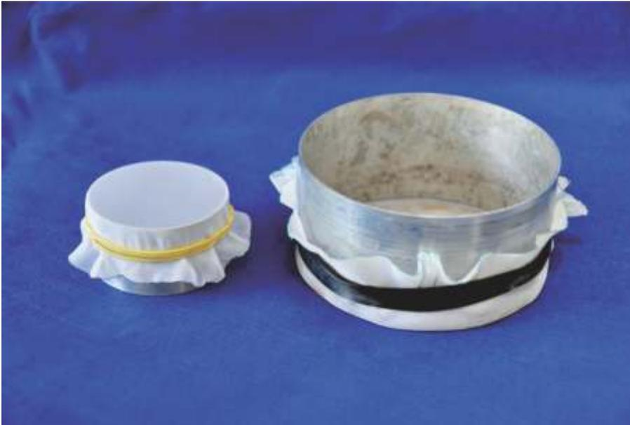
**Figura 7.** Anéis (cilindros de alumínio) cobertos com círculos de *voil* presos por atilho de borracha e por tira de pneu de bicicleta, respectivamente. **Fonte:** Solange Brum.
