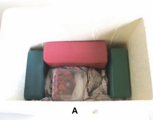
Figura 3 – (A) Correto: Tubos de vidro com tampas de borracha (embalagem primária), dentro de caixa plástica tampada (embalagem secundária), no interior de caixa de isopor (embalagem terciária), com gelo reciclável e folhas de jornal. (B) Incorreto: Amostra em embalagem plástica rompida pelas pedras de gelo soltas na caixa de isopor.
